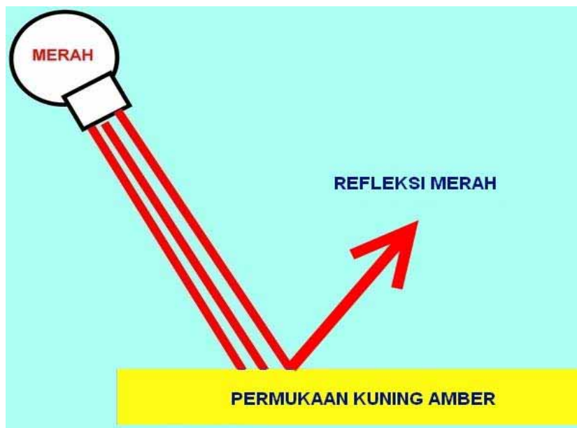
Gb.259 Cahaya berwarna merah akan memantulkan warna merah pada permukaan berwarna kuning amber
